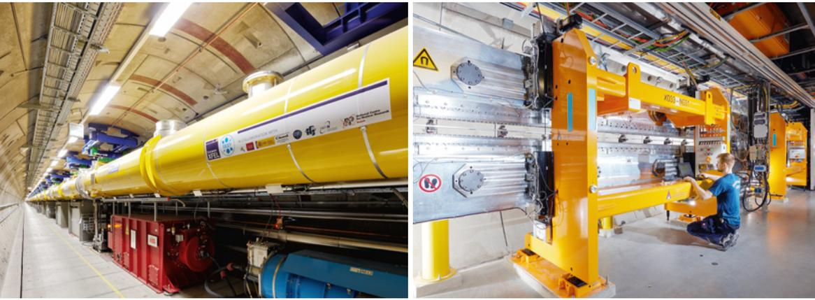
Der Freie-Elektronen-Röntgenlaser (XFEL) befindet sich unter der Erde. Ein 1,7 km langer Teilchenbeschleuniger bringt die Elektronen auf die hohen Energien, die für die Erzeugung der Röntgenstrahlen erforderlich sind. Am Bau der Anlage waren viele Partner beteiligt.
