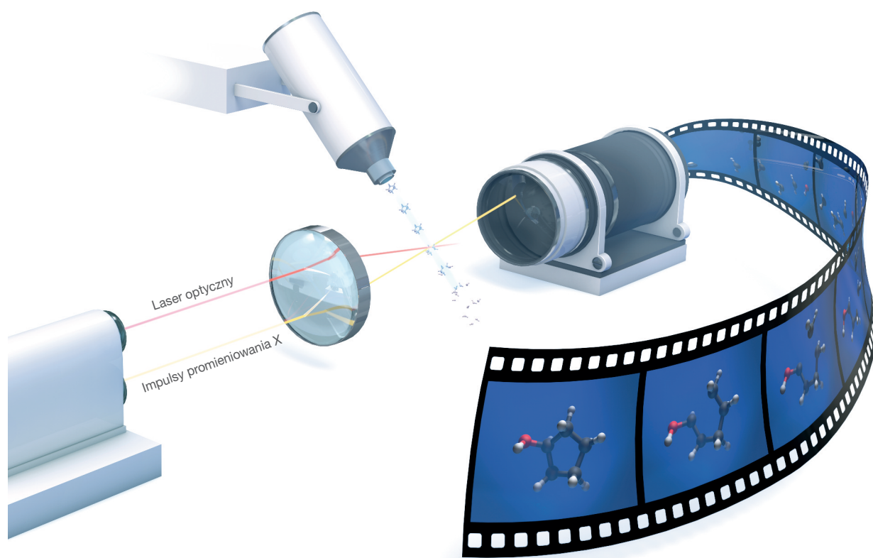
Rys.9 Filmowanie procesów zachodzących w molekułach. Najpierw błyskiem lasera optycznego wywołuje się reakcję chemiczną. Kolejne impulsy z lasera XFEL wysyłane w coraz dłuższym odstępie czasu po pierwszym impulsie optycznym robią "migawki" zmieniającego się stanu molekuly (kolejne klatki filmu).
