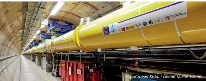
European XFEL расположен в подземных туннелях. Многие партнеры приняли участие в строительстве. Ускоритель частиц длиной 1,7 километра разгоняет электроны до высоких энергий.
