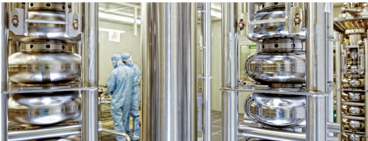
*Рис. 12 Ускорительные технологии, используемые на Европейском XFEL, основывающиеся на специализированных резонаторах из ниобия, уже оказали влияние на развитие линейных ускорителей по всему миру. Рисунок предоставлен DESY.*
