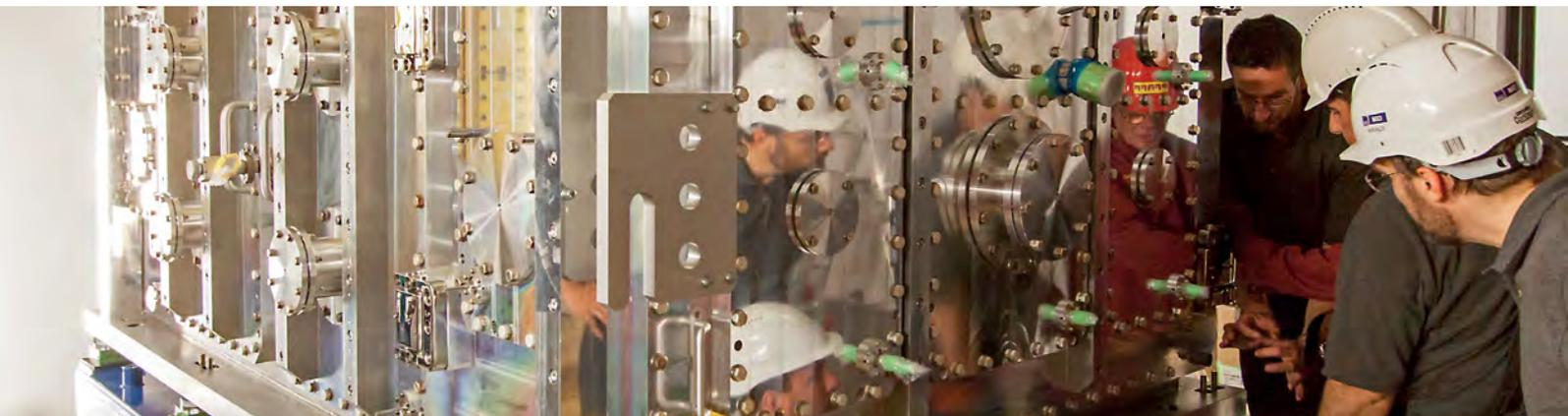
In der HED-Probenkammer können extreme Zustände untersucht werden, wie sie im Inneren von Planeten herrschen.
