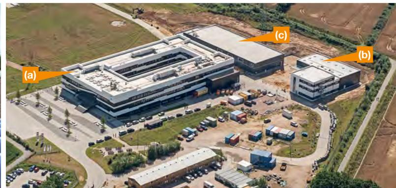
Links: Schematische Darstellung des Zentralgebäudes auf dem European XFEL-Forschungscampus. Die Röntgenblitze gelangen über die Tunnel in die Experimentierhalle unter dem Hauptgebäude, in dem die Labors, Seminarräume und Büros untergebracht sind. Rechts: Luftbild des Zentralgebäudes (a), vom August 2017. Dahinter Werkstatt und Lager (b) sowie die Lüftungszentrale (c).
