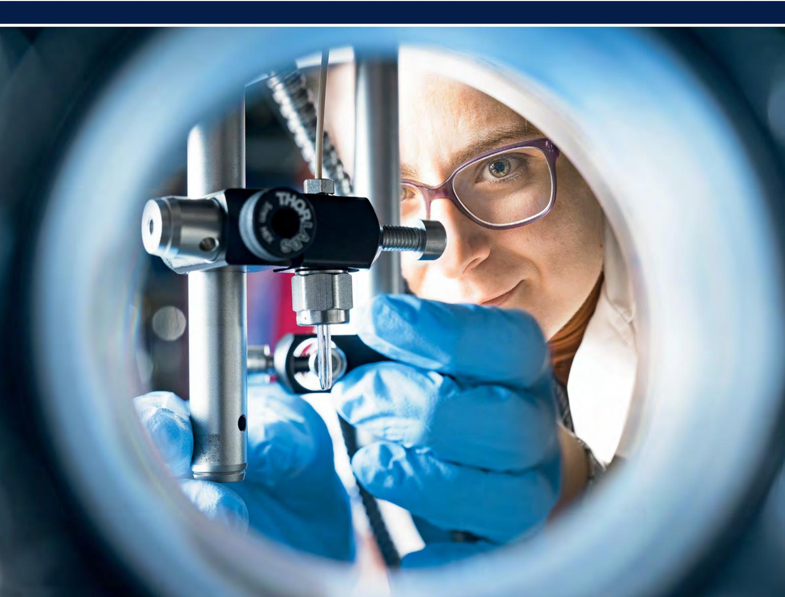
Die Experimentierstationen am European XFEL sind das Ergebnis umfangreicher Forschungs- und Entwicklungsarbeit. Der hier gezeigte Aufbau ermöglicht die Probenzuführung in einem Flüssigkeitsstrahl.
