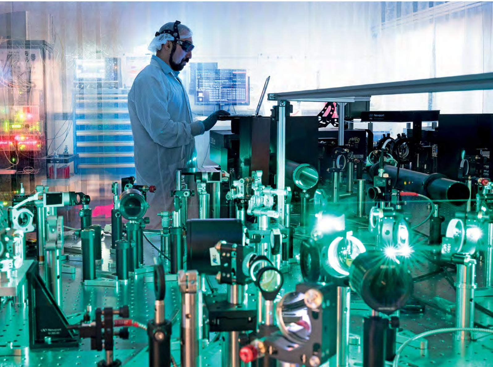
Spezielle Laser starten die Reaktionen, die dann mit den Aufnahmen des Röntgenlasers untersucht werden.
