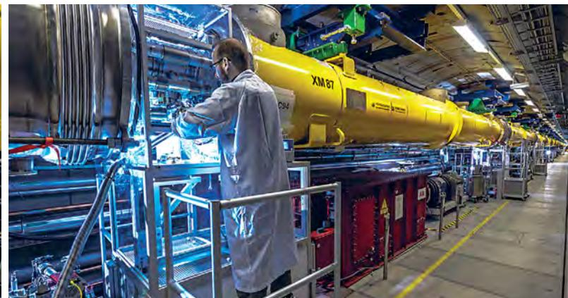
Beim Bau des 1,7-Kilometer langen supraleitenden Elektronenbeschleunigers wurden 96 gelbe Kryomodul an der Tunneldecke montiert. Jedes Modul ist 12 Meter lang.
