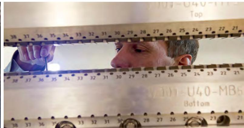
Die Magnete der Undulatoren müssen mikrometergenau eingestellt werden. Nur dann bilden sie das äußerst präzise Magnetfeld, in dem die Röntgenblitze entstehen. Der Abstand zwischen der oberen und unteren Reihe kann variiert werden. Im Betrieb beträgt er zwischen 10 und 25 Millimeter, abhängig von der Elektronenenergie und der gewünschten Wellenlänge.
